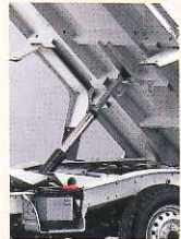
構造がシンプルな直押し式を採用。
